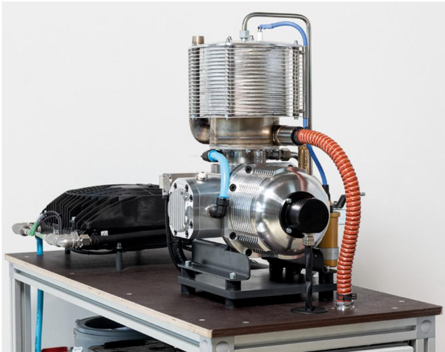
BILD 2 Erster Prototyp des Aggregates mit Kühler-Wärmetauscher (© Highfoto Berghammer)
