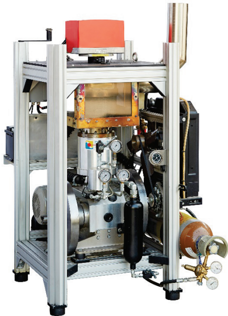
Bild 2: 250 ccm Beta Maschine mit Rhombentrieb
